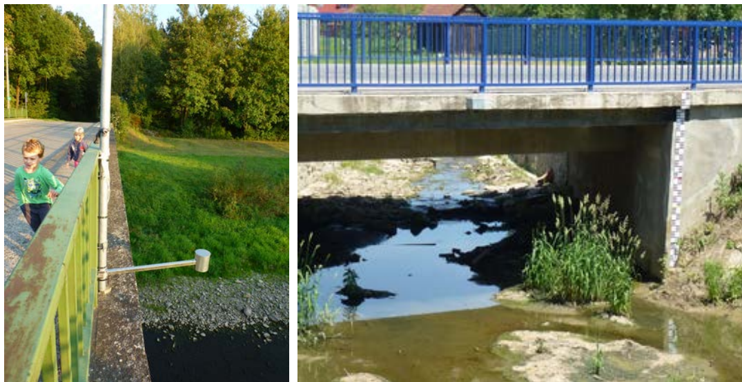
Obrázek 1: Příklad umístění ultrazvukového čidla a měrné lati vodní hladiny
